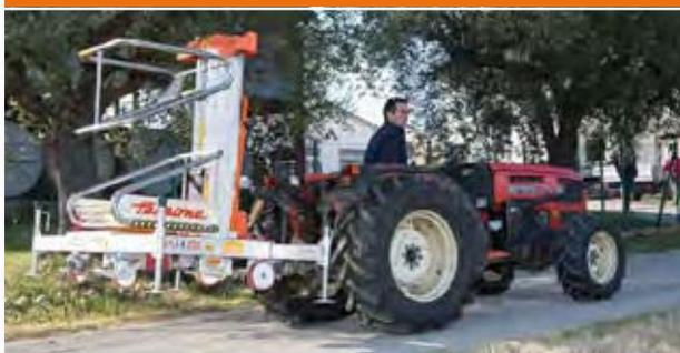
**AT 10.1:** alimentación mediante baterías de 12 v con conexión a la alimentación del tractor.
